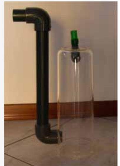
Ho prov-veduto a realizzare una U piegando il PVC a 18 cm di altezza, ottenendo una parte centrale di 11 cm.
