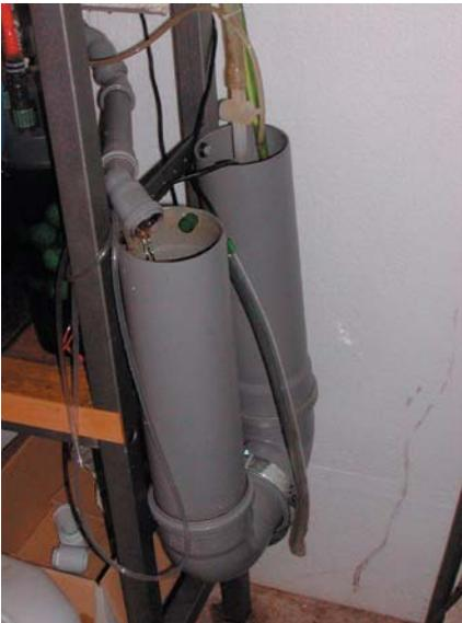
sulla linea dell'alimentazione un termostato ambiente supplementare si può evitare che l'incolarsi dei contatti interni della stufetta porti ad una sovratemperatura e quindi al decesso dei pesci.
