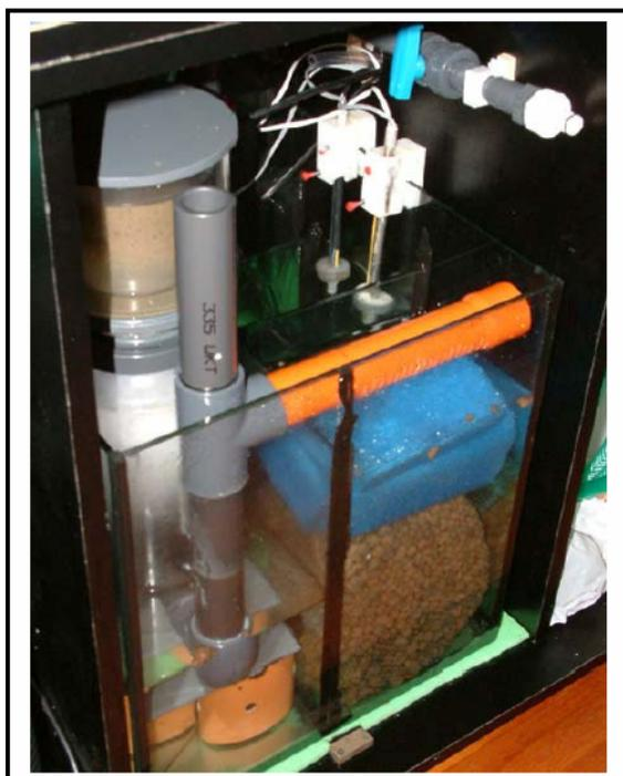
*En este caso la salida del espumador va a parar directamente al compartimento biológico, de forma que todas las partículas gruesas que escapan del espumador quedan retenidas en la filtración mecánica con lana de perlón que se puede retirar fácilmente.*
