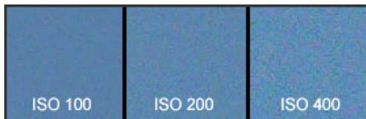
Il rumore è un fenomeno inerente al processo di trasformazione del segnale luminoso in segnale elettrico e dipende da leggi fisiche ineludibili. TUTTI i sensori generano rumore, con quantità variabili in relazione soprattutto alle dimensioni dei fotoelementi che lo compongono. Più i fotositi sono piccoli e vicini uno all'altro, maggiore sarà il livello di rumore generato. Inoltre, il processo di amplificazione è esso stesso fonte di rumore.
